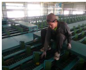
出荷直前の選果場。光センサーの微調整中。
