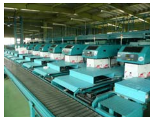
出荷直前の選果場。光センサーの微調整中。
