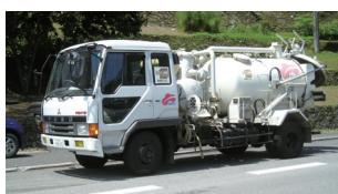
屋根工事専用屋根土吸引車両「クリーンカー」で吉い屋根土から天井裏に落ちた土ほこりまで吸引除去。
