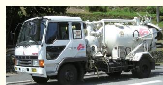
屋根工事専用屋根土吸引車両「クリーンカー」で古い屋根土から天井裏に落ちた土ほこりまで吸引除去。ご近所様にも安心です。
